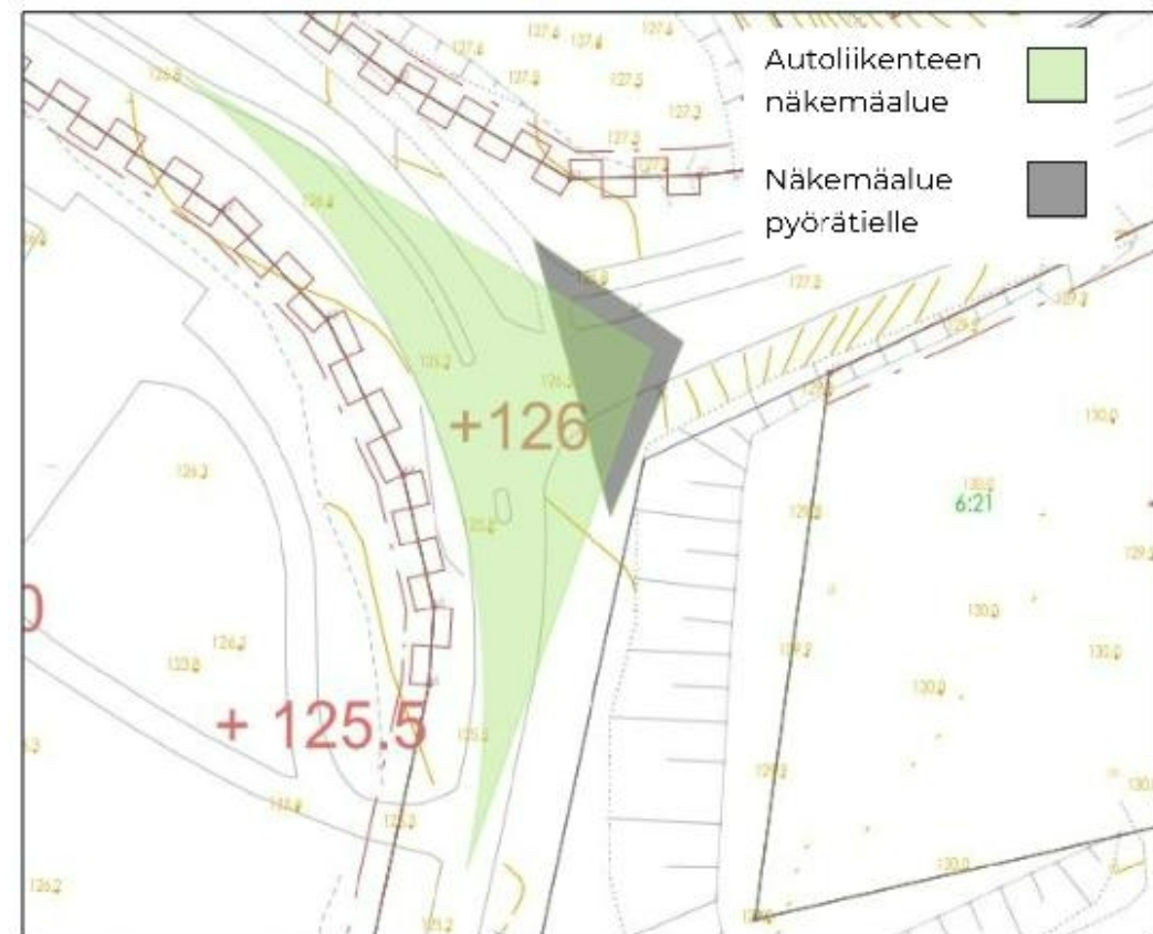
Kuva 14. Ohjeen mukaiset Alumiinitien näkemäalueet auto- ja pyöräliikennettä varten.
