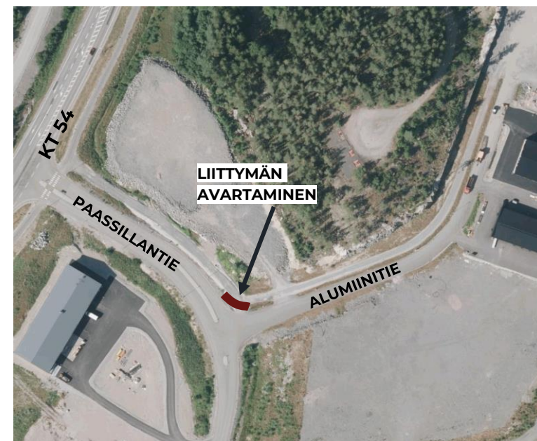
Kuva 13. Suositeltu Alumiinitien ja Paassillantien liittymän kehittämistoimenpide.
