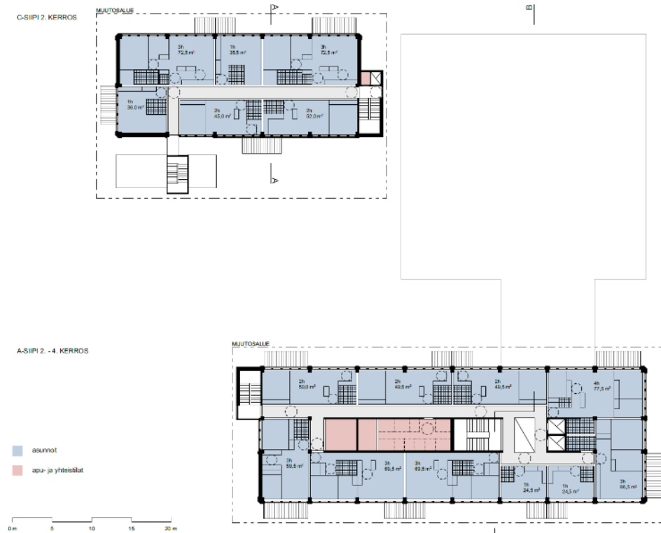
Kuva 10 Hollolan kunnanviraston käyttötarkoituksen muutos, pohjakaaviot peruserkerros.
