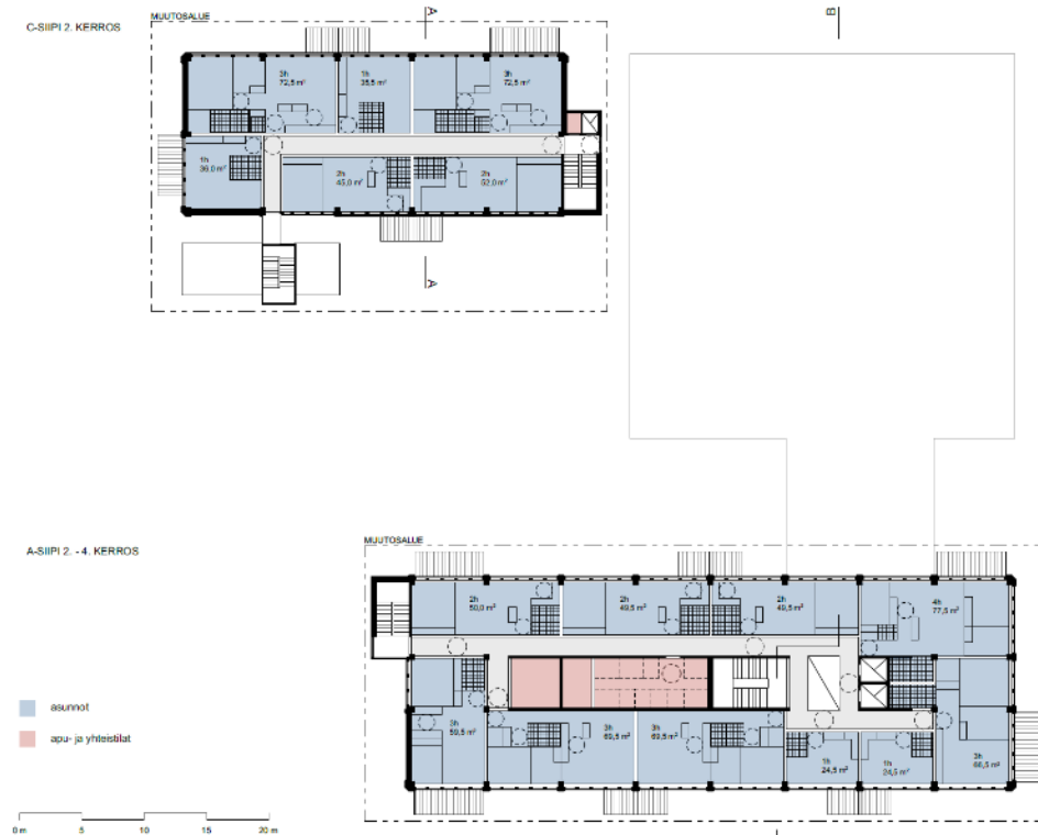
Kuva 10 Hollolan kunnanviraston käyttötarkoituksen muutos, pohjakaaviot peruskerros.
