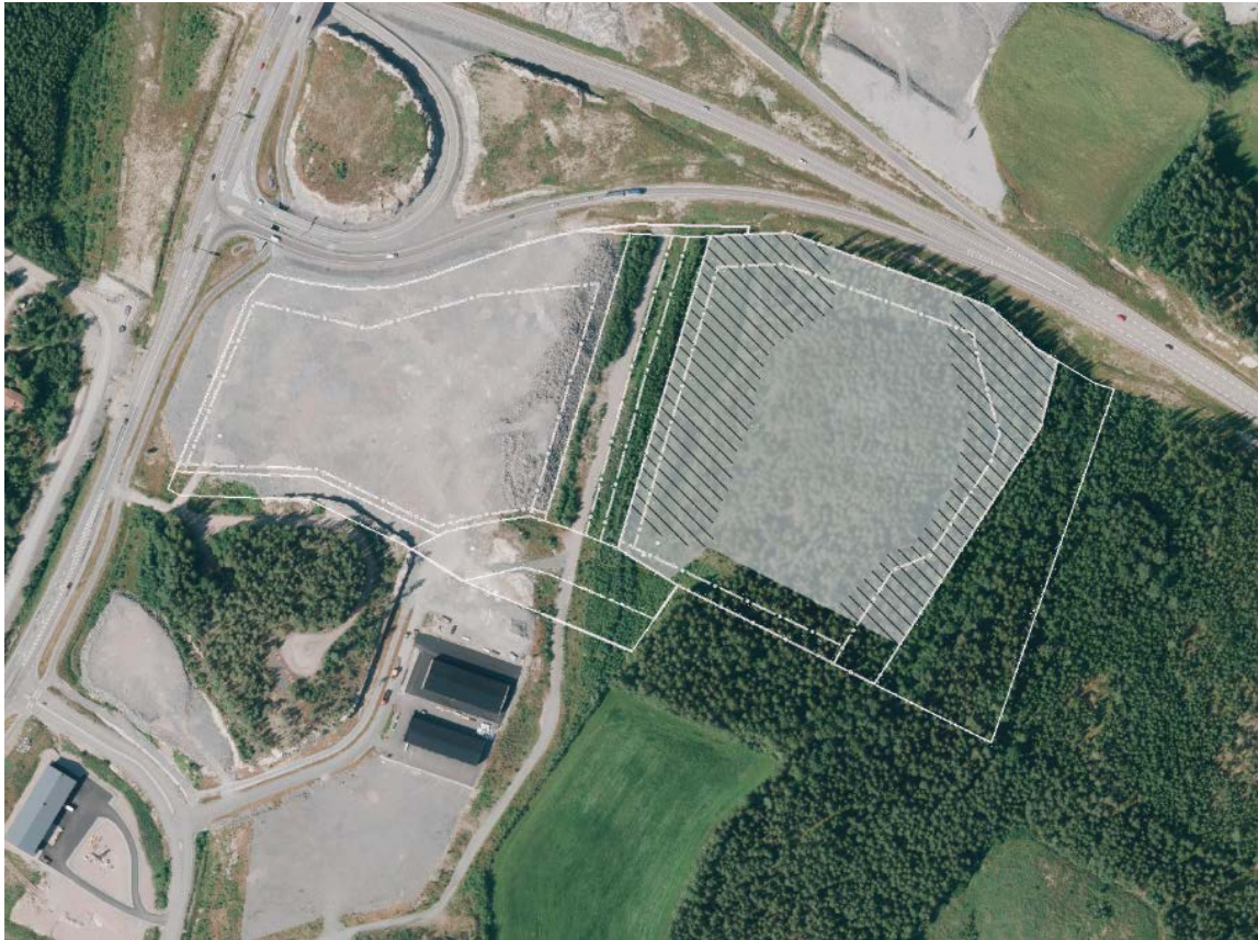
Ilmakuvan päällä harmaalla väritäytöllä on esitetty esirakennettu alue. Musta vinoviivoitus kuvaa täyttöjä ja täyttöjen keskelle jäävä harmaalta alueelta on louhittu maa-ainesta.
