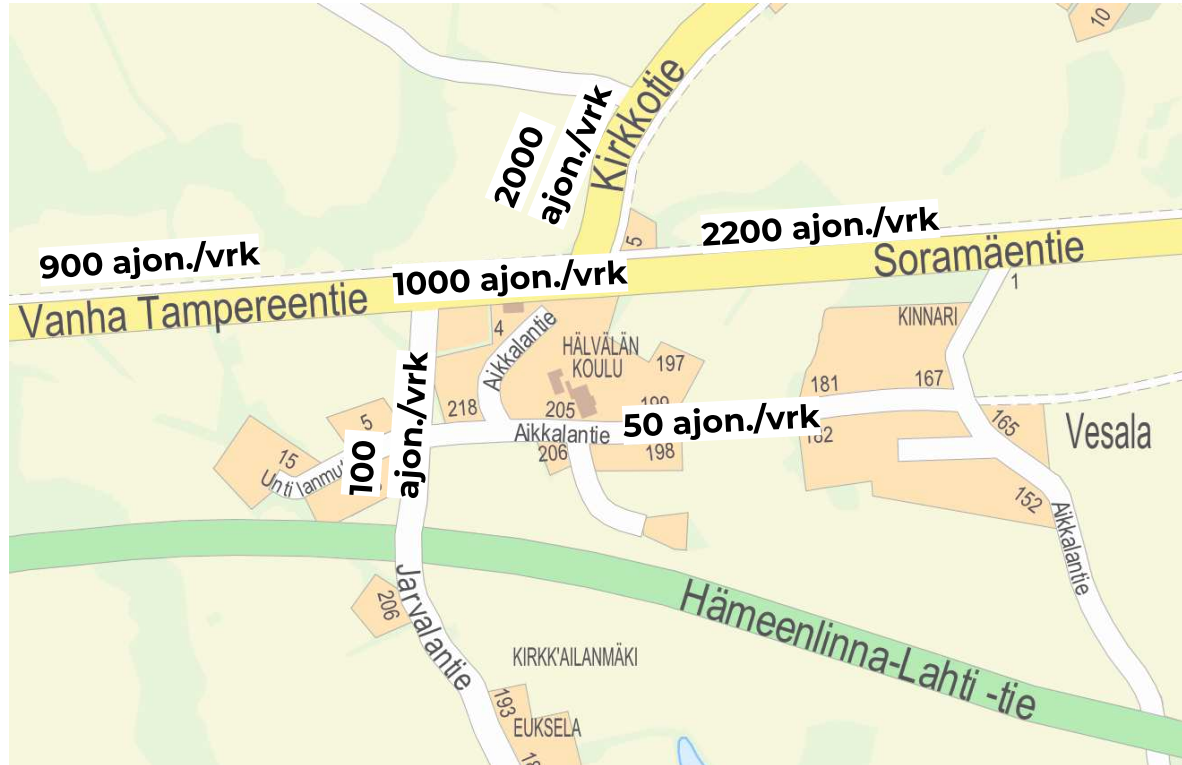
Kuva 4. Asiantuntija-arvio suunnittelualueen nykyliikennemäärästä (KVL, ajon./vrk) perustuen Väyläviraston liikennemäärätietoihin ja Päijät-Hämeen liikennemallin nykytilaennusteeseen.
